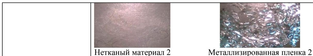
Исследовались следующие механические свойства образцов многослойных утеплителей: разрывная нагрузка и разрывное удлинение. Испытания проведены по стандартным методикам [1-3].
