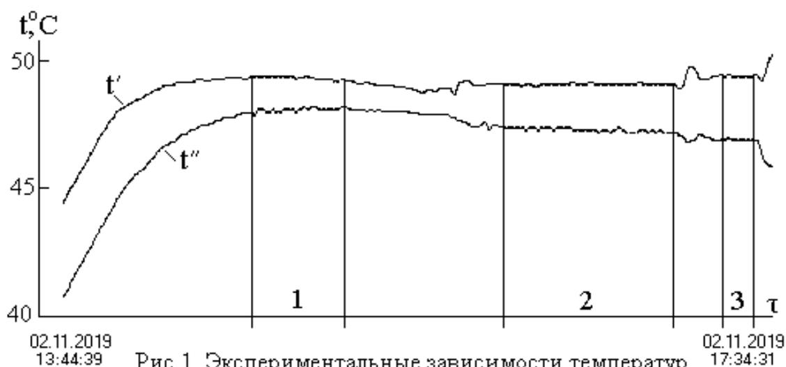
Рис. 1. Экспериментальные зависимости температур жидкости на входе и на выходе из коллектора
